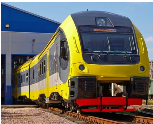
Дизель-поезд с силовым модулем ДП-М
